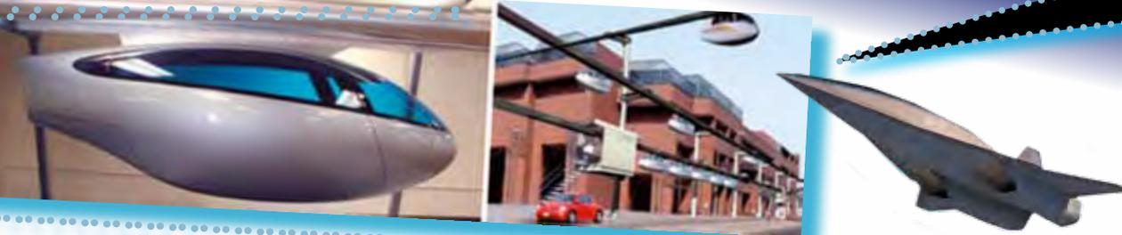
большой высоте сопротивление воздуха меньше. Поскольку поезд на магнитной подвеске плывёт в воздухе, то энергию он расходует в основном на преодоление сопротивления воздуха. Однако если бы поезд на магнитной подвеске ехал в вакууме, то он мог бы развивать скорость до 6440 км/ч. Из-за высокой себестоимости поезда на магнитной подвеске не распространились по миру.
