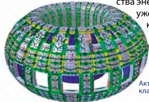
Активная зона реактора ITER – токамак в классическом виде мощностью 500 МВт
