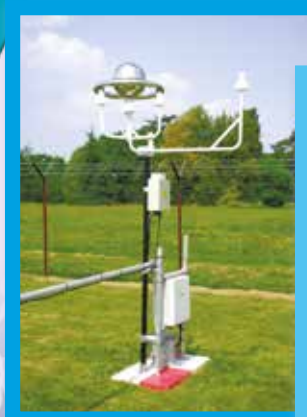
Мал. 1. Зовнішній вигляд датчиків-фіксаторів блискавок, які встановлюють волонтери Blitzortung.org
