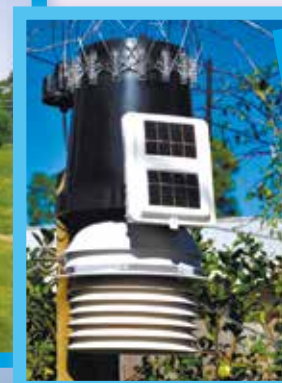
Мал. 1. Зовнішній вигляд датчиків-фіксаторів блискавок, які встановлюють волонтери Blitzortung.org
