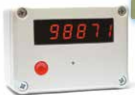
Барометр (атмосферний тиск 98871 Па)
