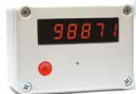
Барометр (атмосферний тиск 98871 Па)
