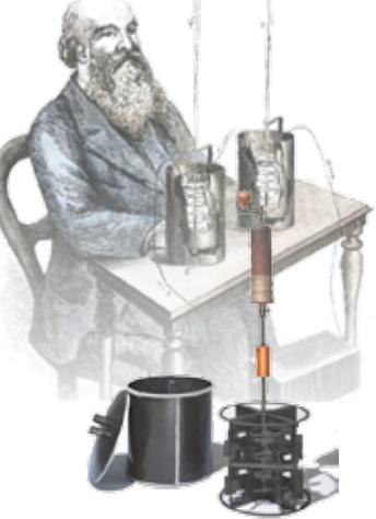
Установка Джоуля для визначення механічного еквіваленту теплоти
