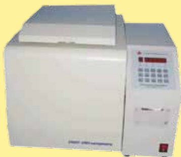
Калориметр для определения калорийности угля, нефти, продуктов питания, древесины, взрывчатки
