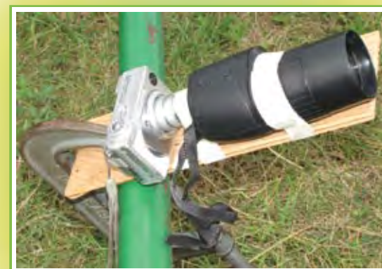
Фото 1. Простий і недорогий монокулярний телескоп „Беркут” має діаметр об'єктива 40 мм і дає 10-кратне збільшення. Камера кріпиться позаду окуляра за допомогою гвинта, затискач утримує апарат на горизонтальній трубі. За допомогою цієї системи зроблено фото 2
