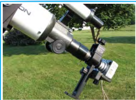
Фото 3. Фотокамера під'єднана до 20-мм телескопа за допомогою фірмового адаптера. Збільшення – 40×. За допомогою цієї установки зроблено фото 4
