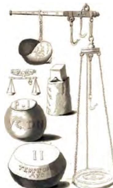
Порівняння римського безміна та рівноплечих давньоримських терезів (скалівів)
