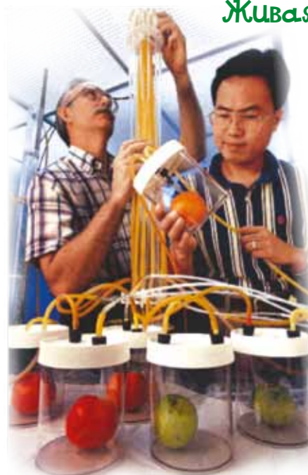
Для определения оптимальных условий хранения плодов учёные измеряют скорость их дыхания и выделения этилена
