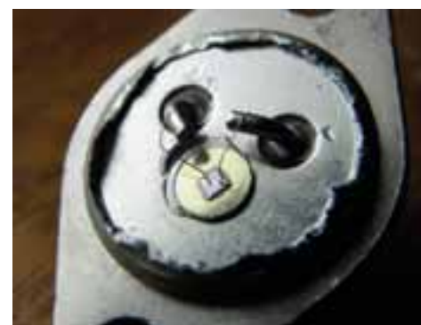
Рис. 1. Кремниевая пластинка внутри полупроводникового транзистора
