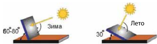
Рис. 3. Выбор угла наклона коллектора в разные времена года
