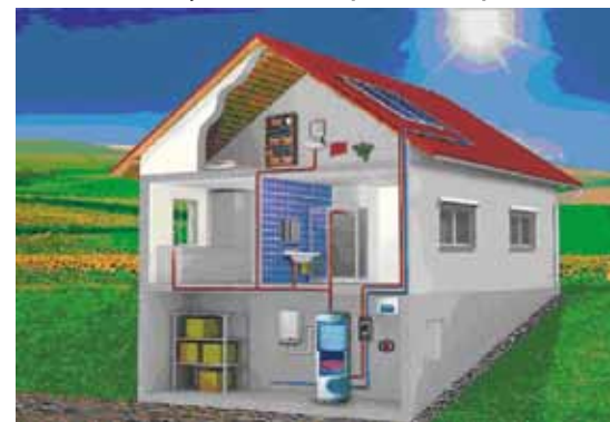
Рис. 2. Фрагмент водонагревательной системы „солнечного” дома
