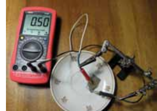
Рис. 5. Измерение напряжения на полюсах гальванического элемента
