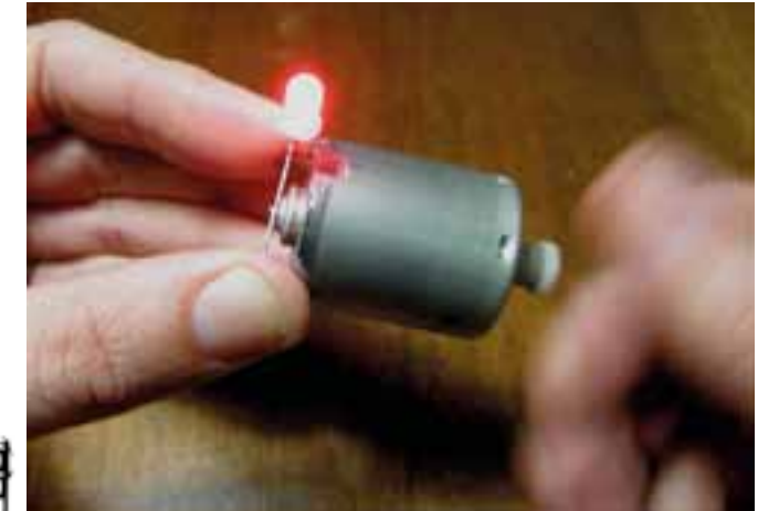
Рис. 6. Электрический двигатель может работать в режиме генератора
