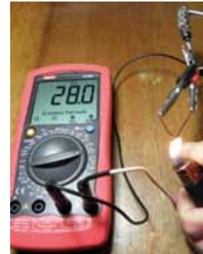
Рис. 8. Термопара – источник тока
