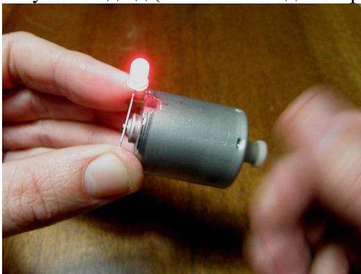
Електричний двигун може працювати в режимі генератора
