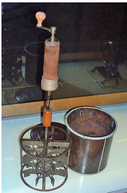
Установка Джоуля для вивчення тепла, 1845 рік
