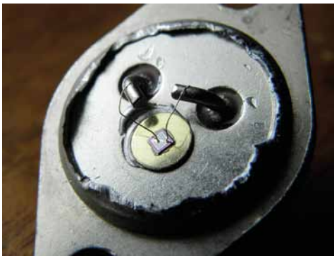
Мал. 1. Кремнієва пластинка всередині напівпровідникового транзистора
