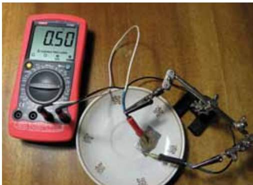
Мал. 5. Вимірювання напруги на полюсах гальванічного елемента
