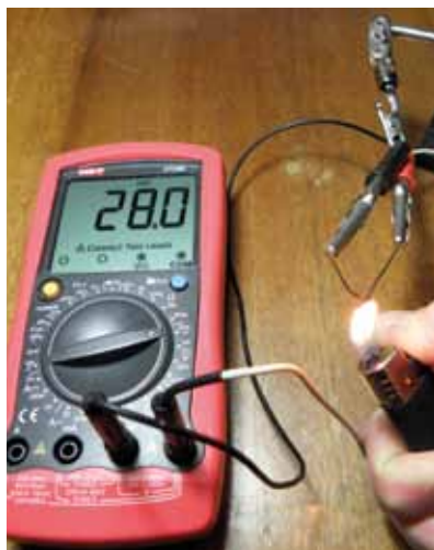
Мал. 8. Термопара – джерело струму
