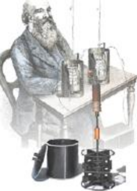
Установка Джоуля для визначення механічного еквіваленту теплоти
