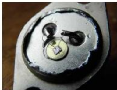
Мал. 1. Кремнієва пластинка всередині напівпровідникового транзистора
