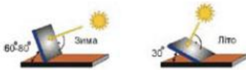
Мал. 3. Вибір кута нахилу колектора в різні пори року
