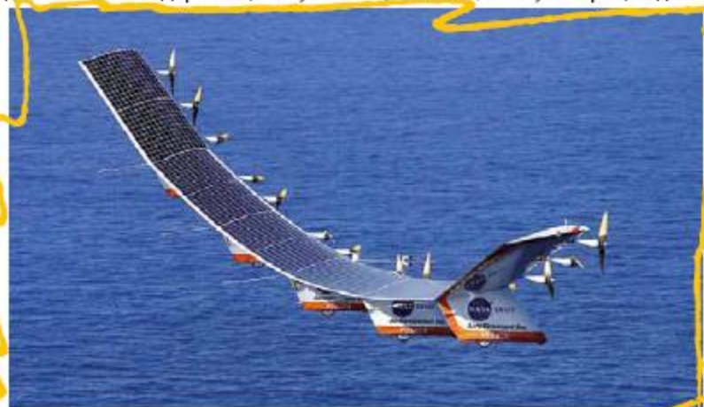
Мал. 3. Безпілотний літак на сонячних батареях
