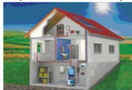
Мал. 2. Фрагмент водонагрівальної системи „сонячного” будинку
