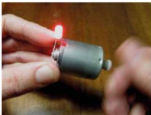
Мал. 6. Електричний двигун може працювати в режимі генератора
