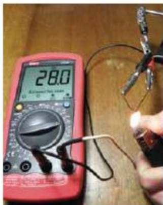
Мал. 8. Термопара – джерело струму
