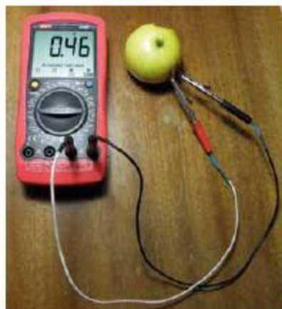
Мал. 3. „Яблучний“ гальванічний елемент
