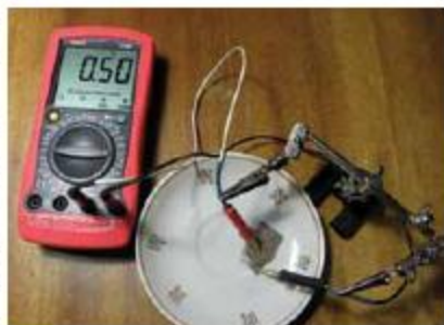
Мал. 5. Вимірювання напруги на полюсах гальванічного елемента
