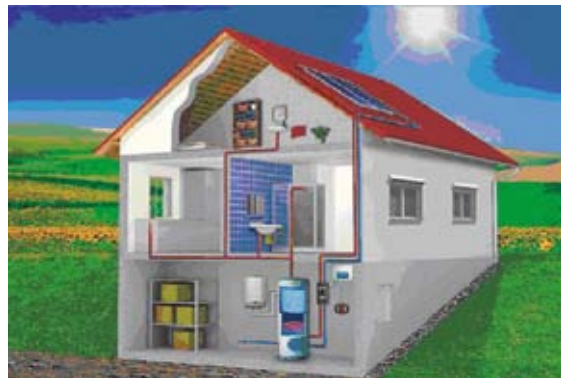
Мал. 2. Фрагмент водонагрівальної системи „сонячного” будинку
