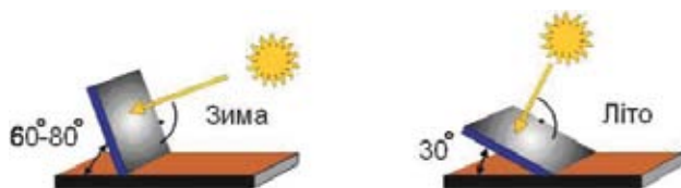
Мал. 3. Вибір кута нахилу колектора в різні пори року
