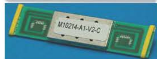
Термінал навігаційної системи GPS та модуль приймача супутникових сигналів
