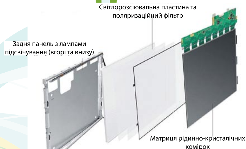
Мал. 1. Будова рідинно-кристалічного монітора
