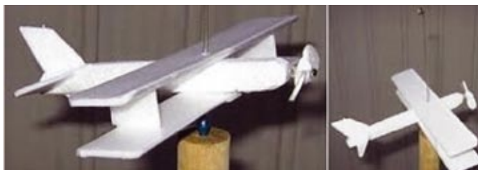
Мал. 4. Флюгер-анеометр у вигляді авіамоделі
