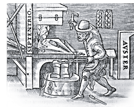
Мал. 4. Виготовлення магніту методом ковки. Гравюра з трактату Вільяма Гільберта
